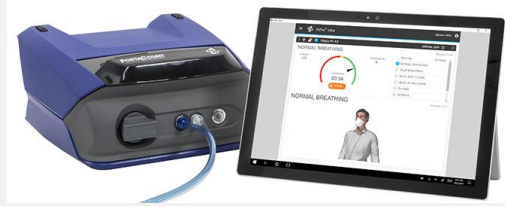
使用機材:短縮定量的フィットテスト装置 Transtech社製 PortaCount8048
